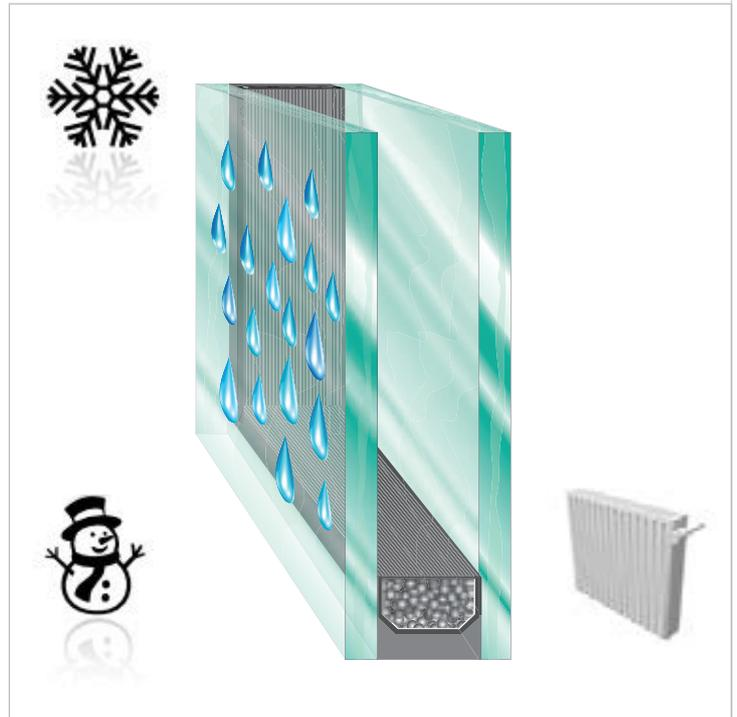
Wird die Taupunkttemperatur der Außenluft unterschritten, fällt Kondensat aus. Eine feuchte Umgebung, z.B. in der Nähe von Gewässern, verstärkt das Problem. In Extremfällen kann das Kondensat auf der Fensteraußenseite sogar anfrieren. Schräg eingebaute Dachflächenfenster sind von dem Effekt stärker betroffen – ähnlich wie beim Pkw Front- und Heckscheibe. Der Effekt
