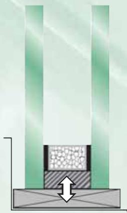
Das ungeeignete Klotzmaterial nimmt Bestandteile aus der zweiten Dichtstufe auf, wird klebrig und plastisch (Abb. 6). Der Klotz verliert seine mechanische Stabilität, so dass die Funktion der Lastabtragung nicht mehr systemgerecht möglich ist. Als Folge daraus können sich zum Beispiel Fensterflügel derart verziehen, dass ein Öffnen und Schließen erheblich behindert oder gänzlich unmöglich wird. Im Endstadium des Migrationsprozesses, wenn sich der Klotz in erheblichen Teilen aufgelöst
